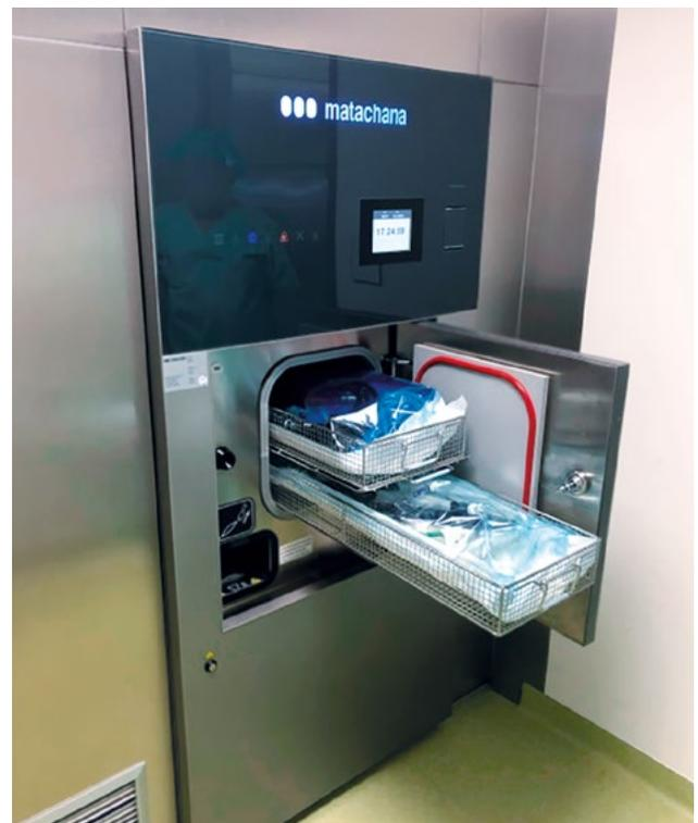
Prueba de carga (carga completa).
