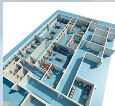
RUMED poseen 3 zonas de trabajo perfectamente separadas mediante barreras físicas conseguidas gracias a las lavadoras termodesinfectoras y la línea de esterilizadores de vapor y baja temperatura, todos ellos de doble puerta
