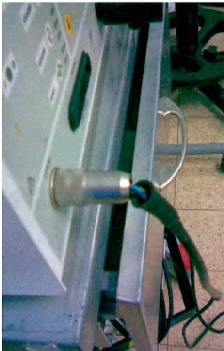
Imagen 2. Cable del pedal de un electrobisturí en mal estado y utilizado en el quirófano.
