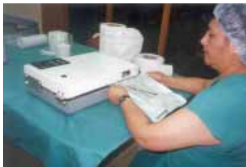
(Fig. No. 16) Se observa una selladora automática, para los empaques mixtos (Seal and peel)
