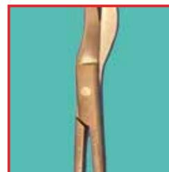
Ataque decapante de la superficie del instrumento. Causa: Ataque del ácido por sobredosis.
