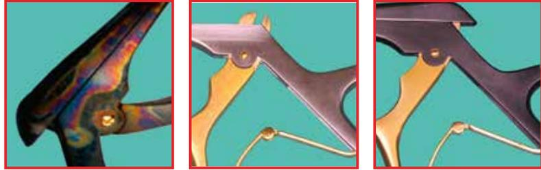
Ejemplo: punzón negro revestido de TiAlN. Mediante la eliminación parcial de la capa brillante manchada o completamente descapada con los componentes dorados intactos.
