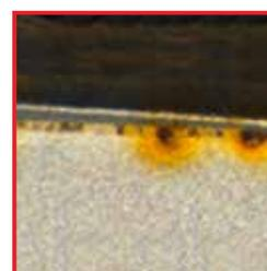
Ataque decapante de las costuras de soldadura. En tijeras de metal duro, pinzas de metal duro y portaguijas Causa: Ataque de ácido por sobredosis del agente químico neutralizador o la aplicación de productos de limpieza básicos.
