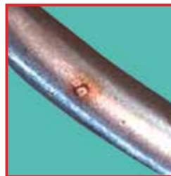
Corrosión de picadura en unas pinzas. Causa: El envejecimiento acelerado de la cinta de código cromático permite la infiltración de sustancias perjudiciales con cloruro.
