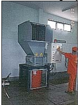
Fig. 4 y 5. Triturador de residuos sólidos
